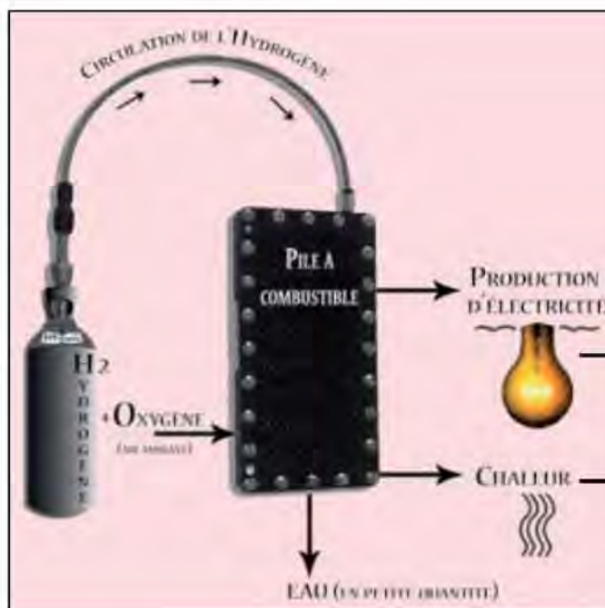
Schéma de fonctionnement d'une pile à combustible :
